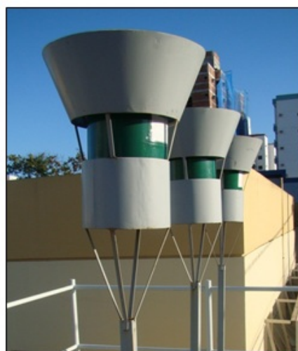
Figura 4.5 Coletor de partículas sedimentadas projetado de acordo com a norma ASTM D1739.
